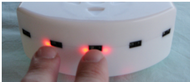
FIGURE 4.1 – L'avant de Thymio. Deux doigts sont détectés par les capteurs avant.
