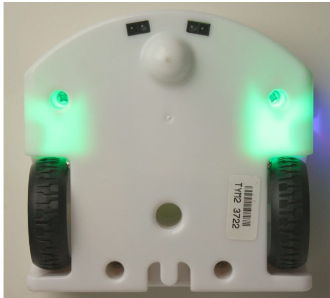
FIGURE 3.2 – Le dessous de Thymio avec ses détecteurs de sols
