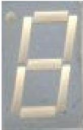
Nous avons eu une première approche de la carte Arduino avec le côté électronique et le côté programmation. Nous avons tout d'abord eu recours à l'afficheur 7 segments.
